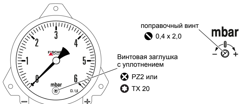
Рис. 6: Настройка нулевой точки
