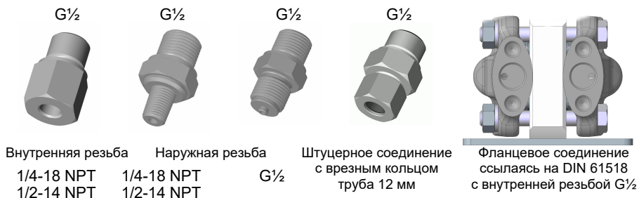
Рис. 2: Параметры для технических подключений
