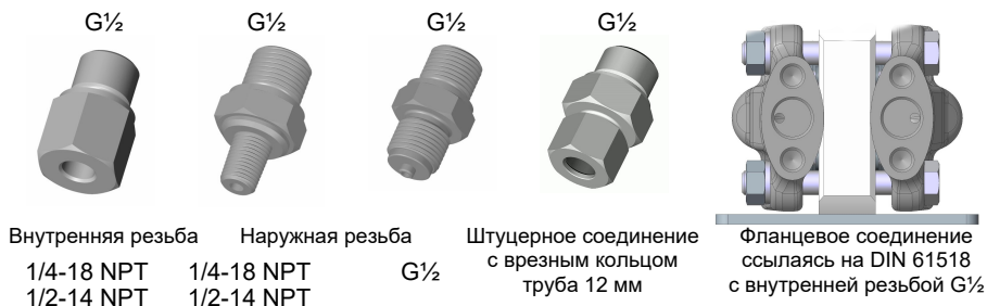
Рис. 2: Параметры для технических подключений
