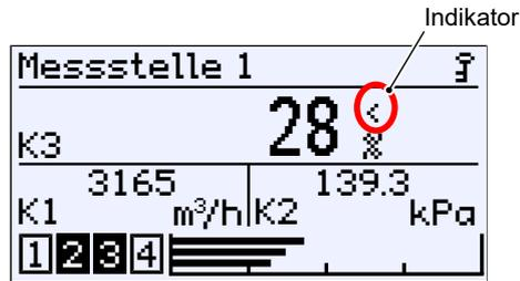
Abb. 117: Nullpunkt-Fenster Verschmutzungsgrad
