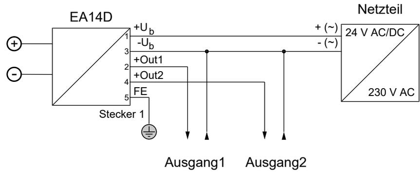
Abb. 8: Anschluss Analogausgänge
