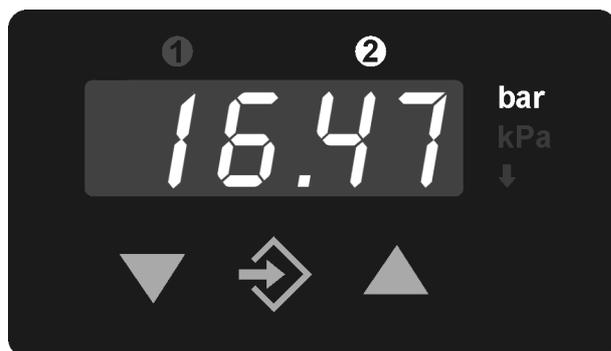
Die 3½ stellige LED-Anzeige stellt im Normalbetrieb den aktuellen Druck dar. Rechts von der Anzeige wird die gewählte Messeinheit hinterleuchtet. (Hinweis: Die auf dem Bild dargestellten Einheiten können von der tatsächlichen Ausführung abweichen.) Oberhalb der Anzeige symbolisieren die zwei Leuchtdioden ❶ ❷ den Zustand der Schaltausgänge (LED leuchtet = Schalter ist geschlossen).
