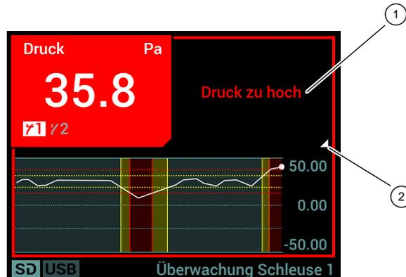
Abb. 10: Detailsicht Alarmmeldung
