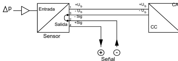
Fig. 4: Circuito de 3 conductores con puente interno -U<sub>b</sub> / -Sig
