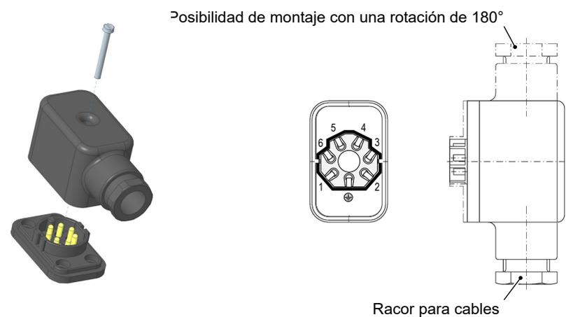
Fig. 7: Clavija de cable
