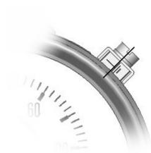
Fig. 9: Raccord de mise à la terre
