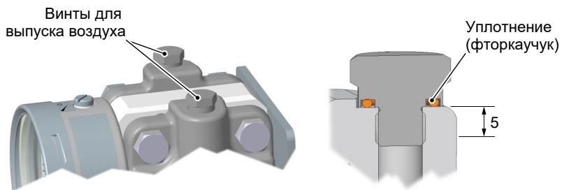
Рис. 15: Удаление воздуха в случае с жидкими веществами
