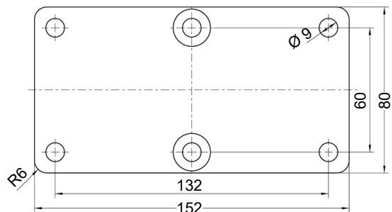
Рис. 21: Схема установки (крупная измерительная система  $\varnothing$  130)
