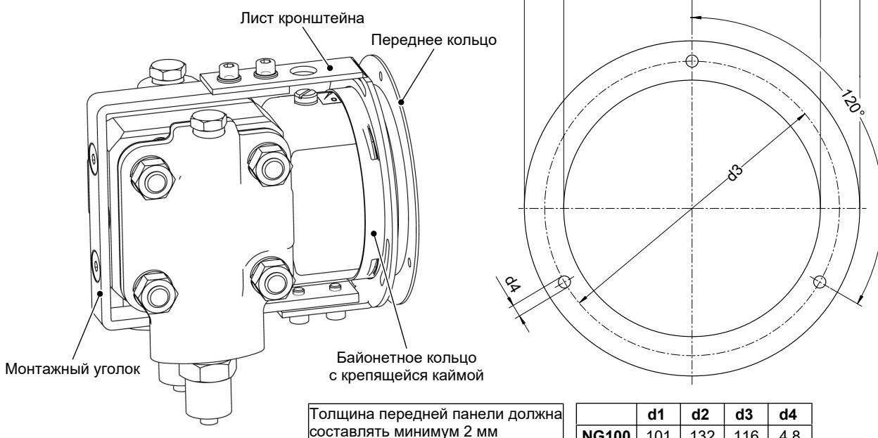
Рис. 22: Установка на передней панели с комплектом для монтажа на панель
