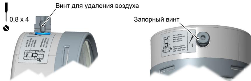
Рис. 14: Воздушный клапан
