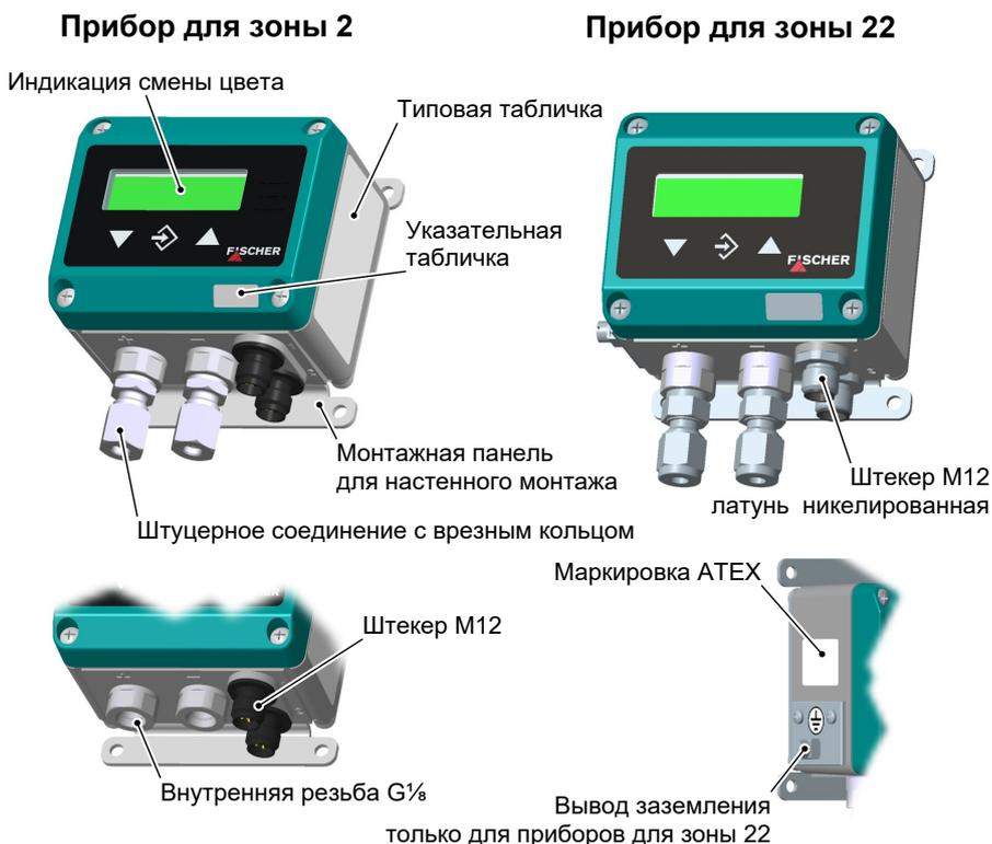
Рис. 2: Варианты исполнения прибора
