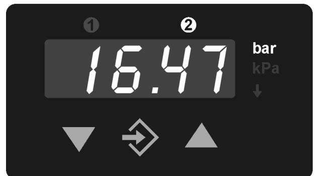
Die 3½ stellige LED-Anzeige stellt im Normalbetrieb den aktuellen Differenzdruck dar. Rechts von der Anzeige wird die gewählte Messeinheit hinterleuchtet. (Hinweis: Die auf dem Bild dargestellten Einheiten können von der tatsächlichen Ausführung abweichen.) Oberhalb der Anzeige symbolisieren die zwei Leuchtdioden  $\neq$  2 den Zustand der Schaltausgänge (LED leuchtet = Schalter ist geschlossen).
