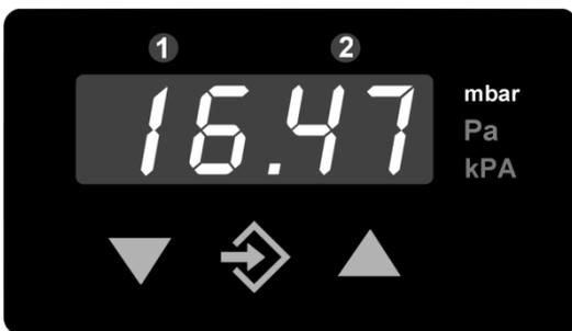
Die 3½ stellige LED-Anzeige stellt im Normalbetrieb den aktuellen Differenzdruck dar. Rechts von der Anzeige wird die gewählte Messeinheit hinterleuchtet. (Hinweis: Die auf dem Bild dargestellten Einheiten können von der tatsächlichen Ausführung abweichen.) Oberhalb der Anzeige symbolisieren die
