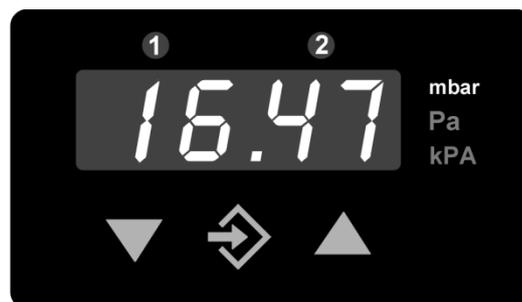
3½ разрядная светодиодная индикация показывает в нормальном режиме существующее давление. Справа подсвечивается выбранная единица измерения. (Примечание: показанные на рисунке единицы измерения могут быть на реальном приборе другими.) Сверху светодиоды символизируют состояние выходных контактов ① ② (если светодиод светит, значит, контакт соединен).
