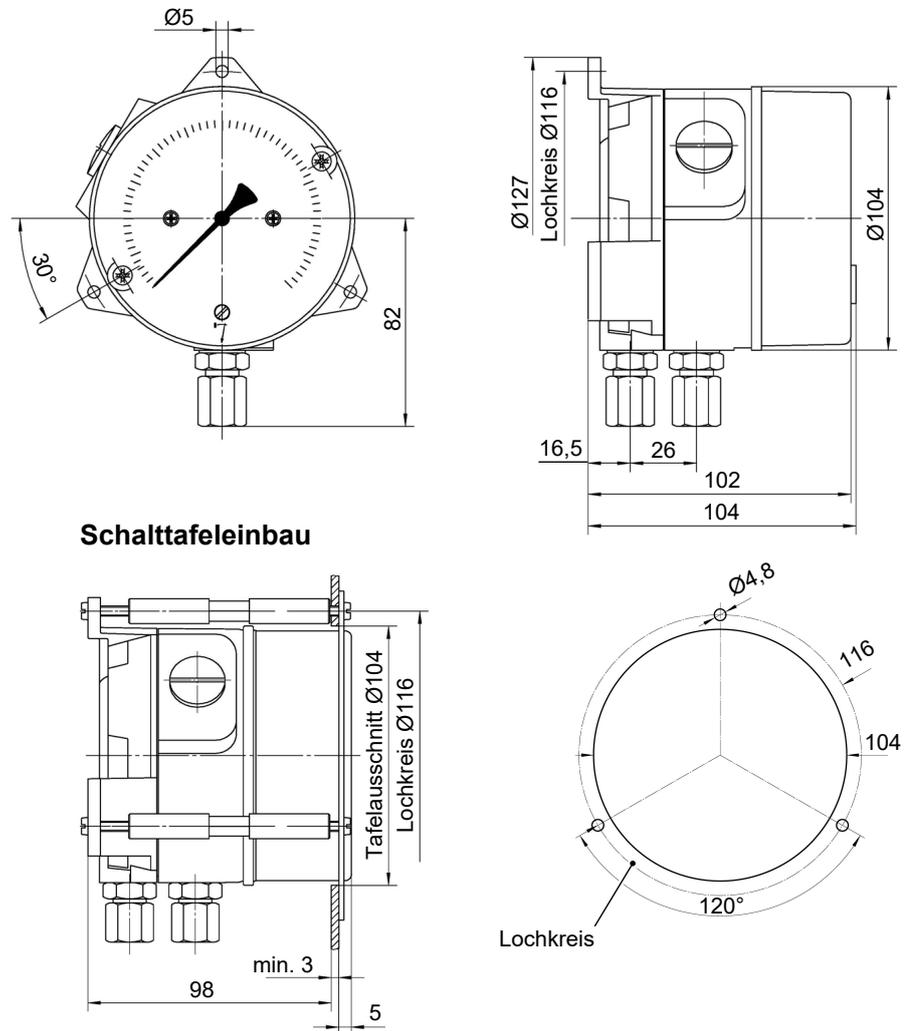
Abb. 2: Maßbild Druckkammer Aluminium
