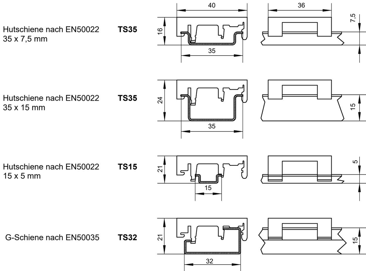
Abb. 11: Maßbild Tragschienenmontage
