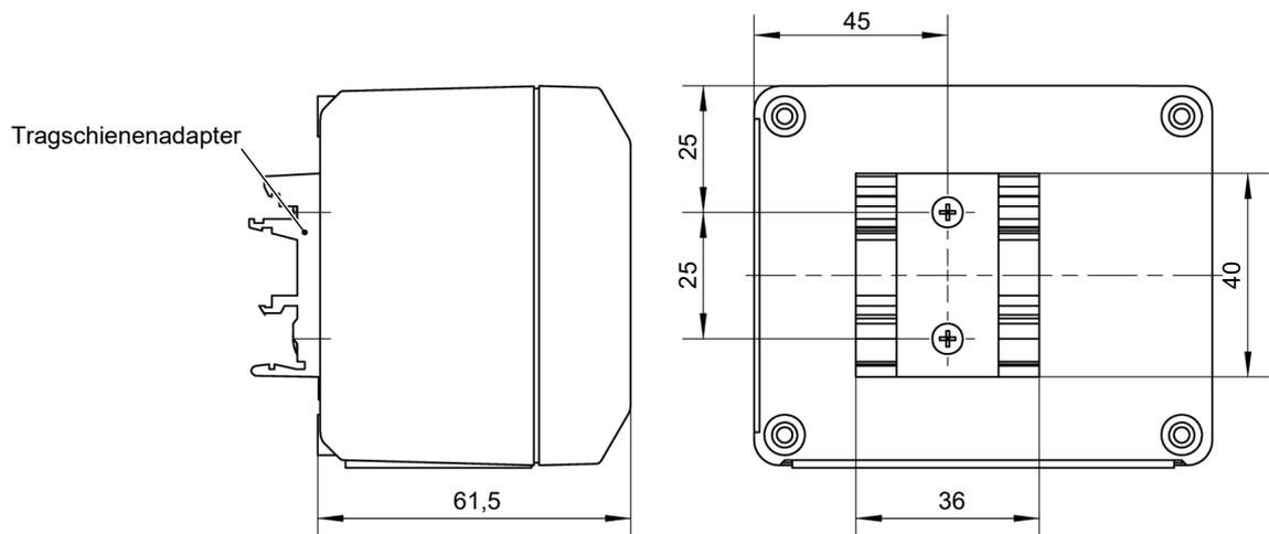
Mit dem Tragschienenadapter ist das Gerät auf den folgenden Tragschienen montierbar:
