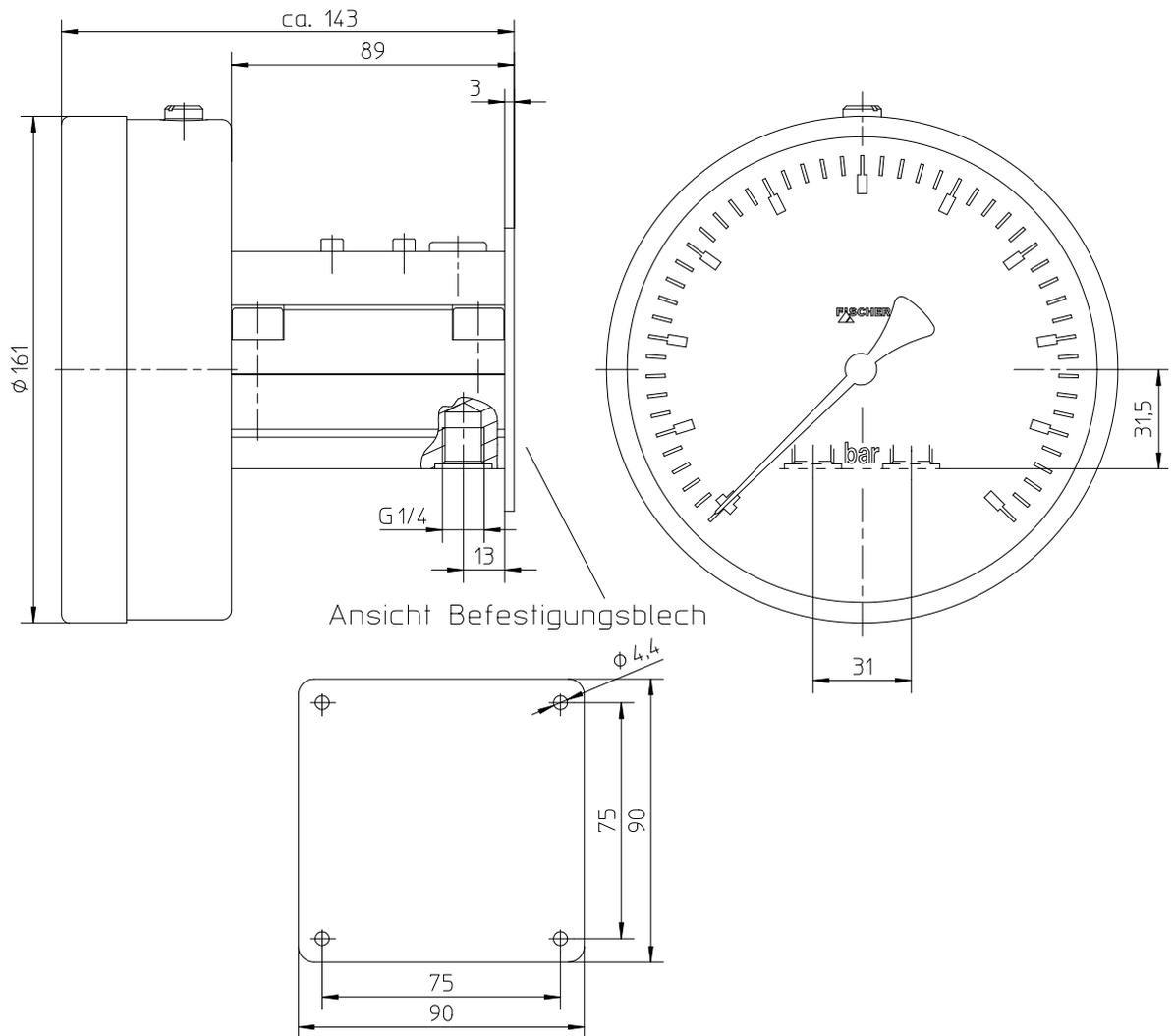
DA30 mit Bajonettringgehäuse  $\varnothing$  100 mm
