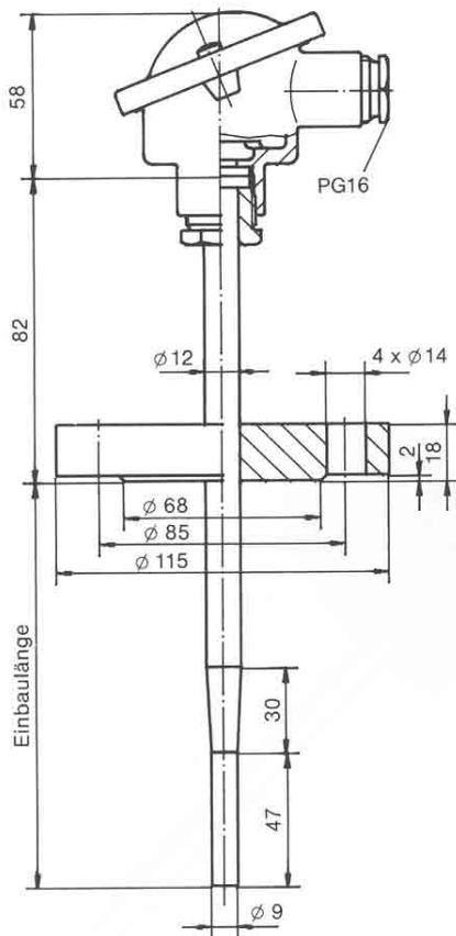
**Mechanische und thermische Belastbarkeit des Schutzrohres**
