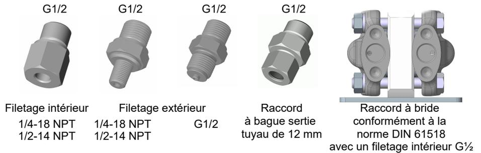
Fig. 2: Options pour le raccordement du process
