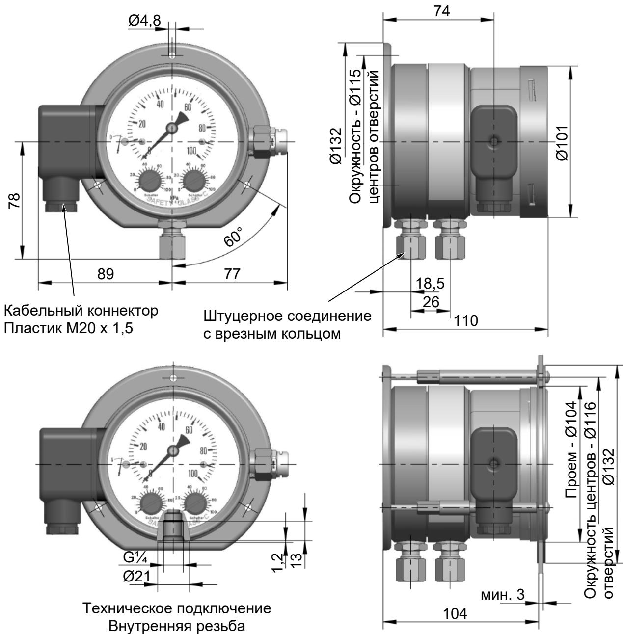
Рис. 9: Напорная камера из нержавеющей стали (IP65)
