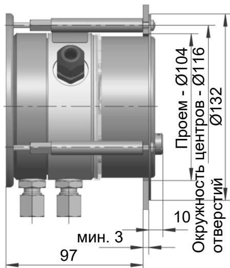
Рис. 8: Напорная камера из нержавеющей стали (IP55)
