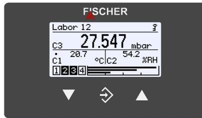
Abb. 14: Feuchte- und Temperaturanzeige
