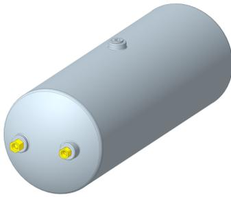
Druckbehälter zur Dämpfung atmosphärischer Schwankungen auf dem Referenzdrucksignal in druckgeregelten Räumen. Die Amplitude des atmosphärischen Druckes wird auf ein stabiles Signal geglättet. Das geglättete Signal wird als Referenz für nachfolgende Raumdruckregelkreise verwendet.
