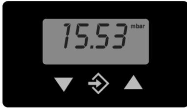
Die 4-stellige LC-Anzeige stellt im Normalbetrieb den aktuellen Druckwert dar. Die Einheit wird rechts neben dem Messwert dargestellt.
