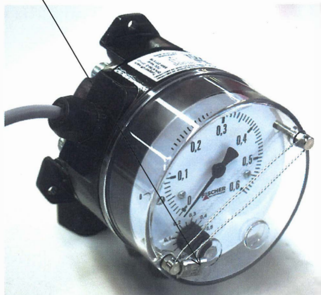
Рисунок 2 — Схема пломбировки манометров от несанкционированного доступа
