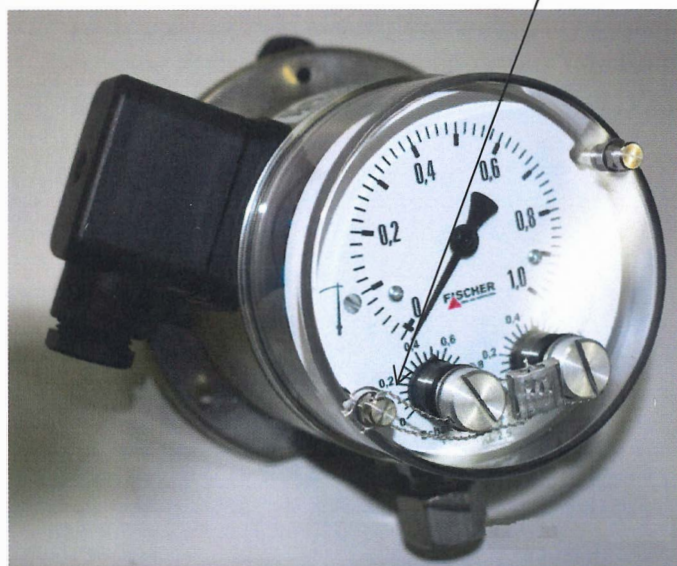
Рисунок 2 — Схема пломбировки манометров от несанкционированного доступа
